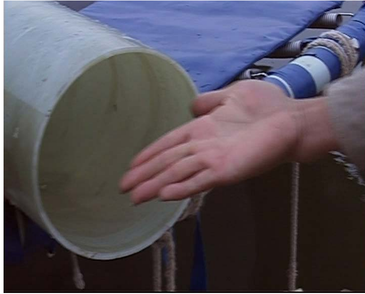
图 1 类礁石夹砂玻璃钢管输海水试验
